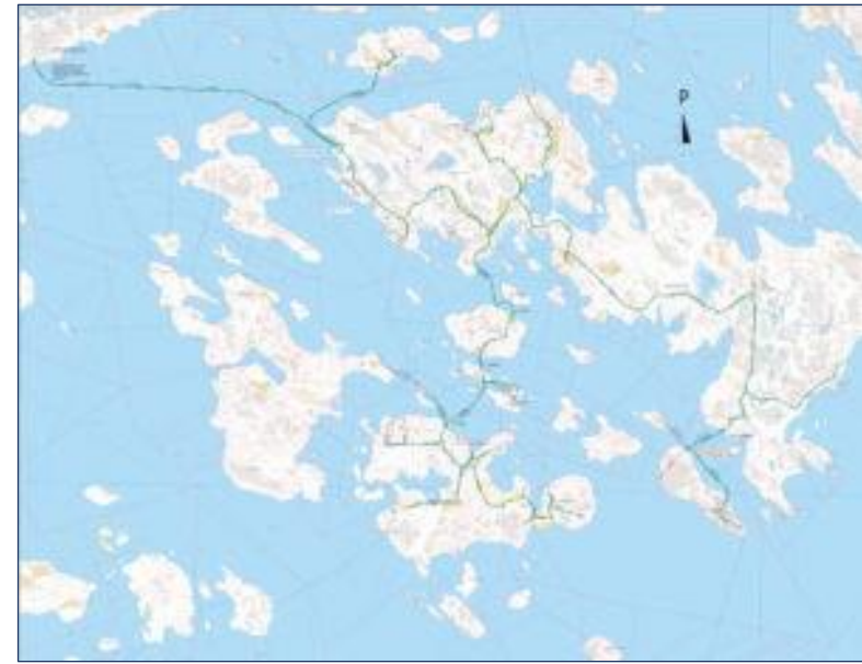
Kuva 7. Sipoon saariston keskiosassa sijaitseva vesi- ja viemäriverkosto, rakennusvaihe 1, Sibbe vesihuolto-osuuskunta
