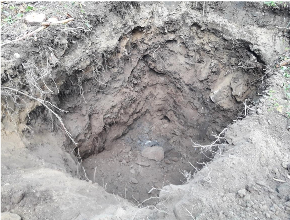
Kuva 02. Kuvassa näkyy kaivettu koekuoppa KK2 noin 3,5 metriin asti. Maalajiprofiili on hiekaista, siltistä, kivistä, ja lohkareista täyttömaata. Jätettä ei koekuopassa havaittu mutta 2,5-3,5 metrissä todettiin maatunutta puuta. Oletettu luonnonmaa (savinen hiekka) todettiin 3,5-4,5 metrissä.
