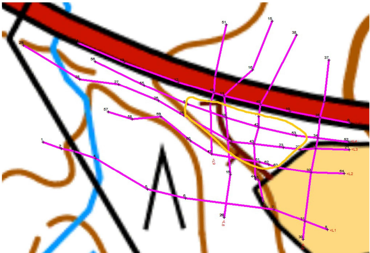
Kuva 2. Maatutkaluotauslinjat ja jätetäytön arvioitu laajuus. Maatutkalinjat esitetty purppuran värisinä viivoina ja tutkimuksessa arvioitu jätetäytön/täyttömaan alue keltaisella rajauksella.
