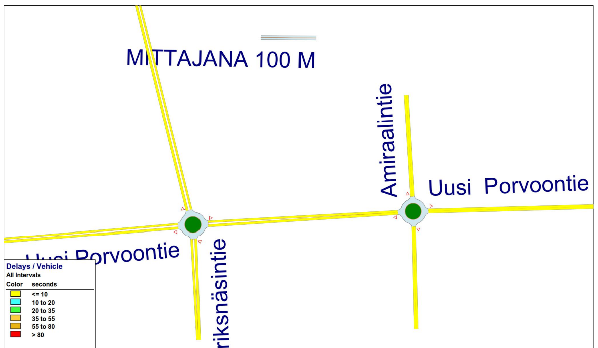
Kuva 11. Keskimääräiset ajoneuvoviivytykset aamuhuipun ennusteliikenteellä Söderkullantien ja Amiraalintien liittymässä Uudella Porvoontiellä, jos Söderkullantien liittymä rakennetaan kierto liittymäksi.
