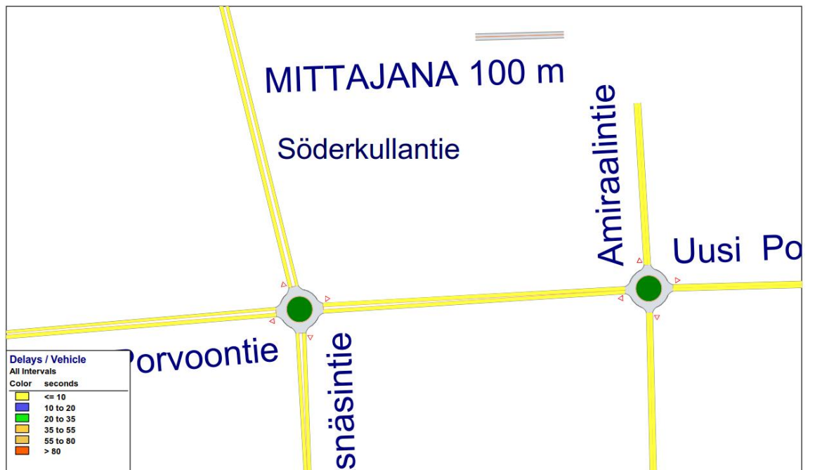
Kuva 7b. Keskimääräiset ajoneuvoviivytykset iltahuipun ennusteliikenteellä Söderkullantien ja Amiraalintien liittymässä Uudella Porvoontien, jos Söderkullantien liittymä rakennetaan kiertoliittymäksi.
