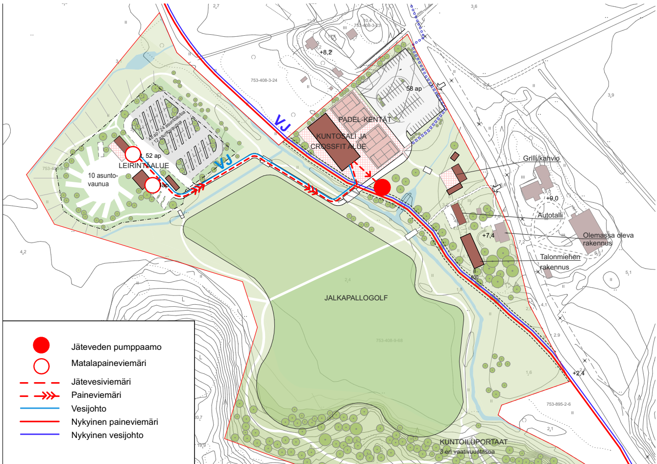
Kuva 5.6. Periaatekuva alueen vesihuollon järjestämisestä.
