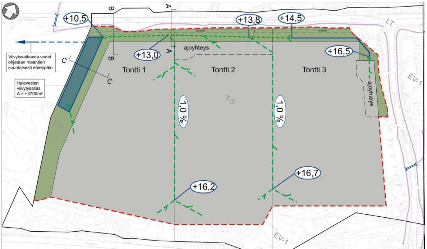
Kuva 5. Asemakaavaehdotuksen mukaisen suunnitteluratkaisun hulevesijärjestelmä: hulevesiviemärit (vihreä katkoviiva), avo-oja (sininen katkoviiva), viivytysallas (sininen nelikulmio) (A-Insinöörit Suunnittelu Oy, 27.1.2016).
