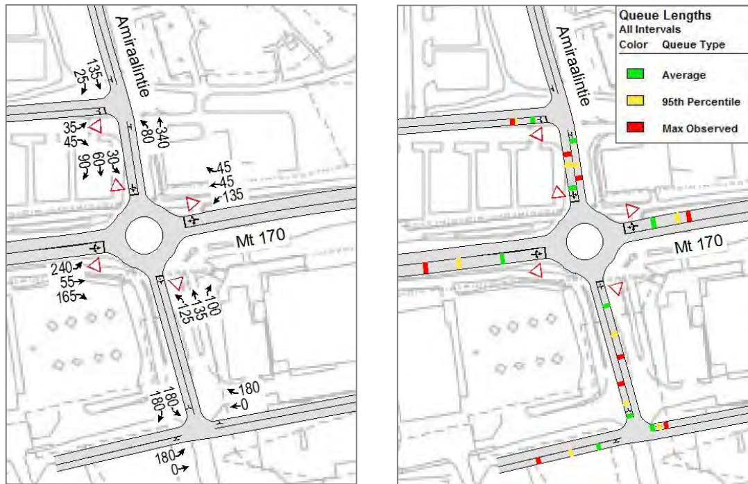
Kuva 5. Söderkullan keskustan ennustetilanteen 2020 liikennemäärät ja jonopituudet illan huippu-tunnilla (kuva: Synchro).
