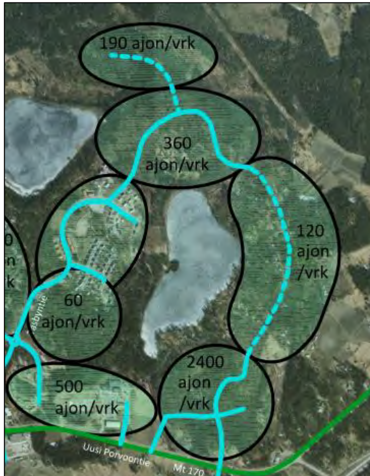
Kuva 10. Pohjois-Taasjärveltä Pähkinälehtoon kulkevan yhteyden liittyminen Graniittitien kautta Uuteen Porvoontiehen (mt 170), ajoneuvoa/vrk.
