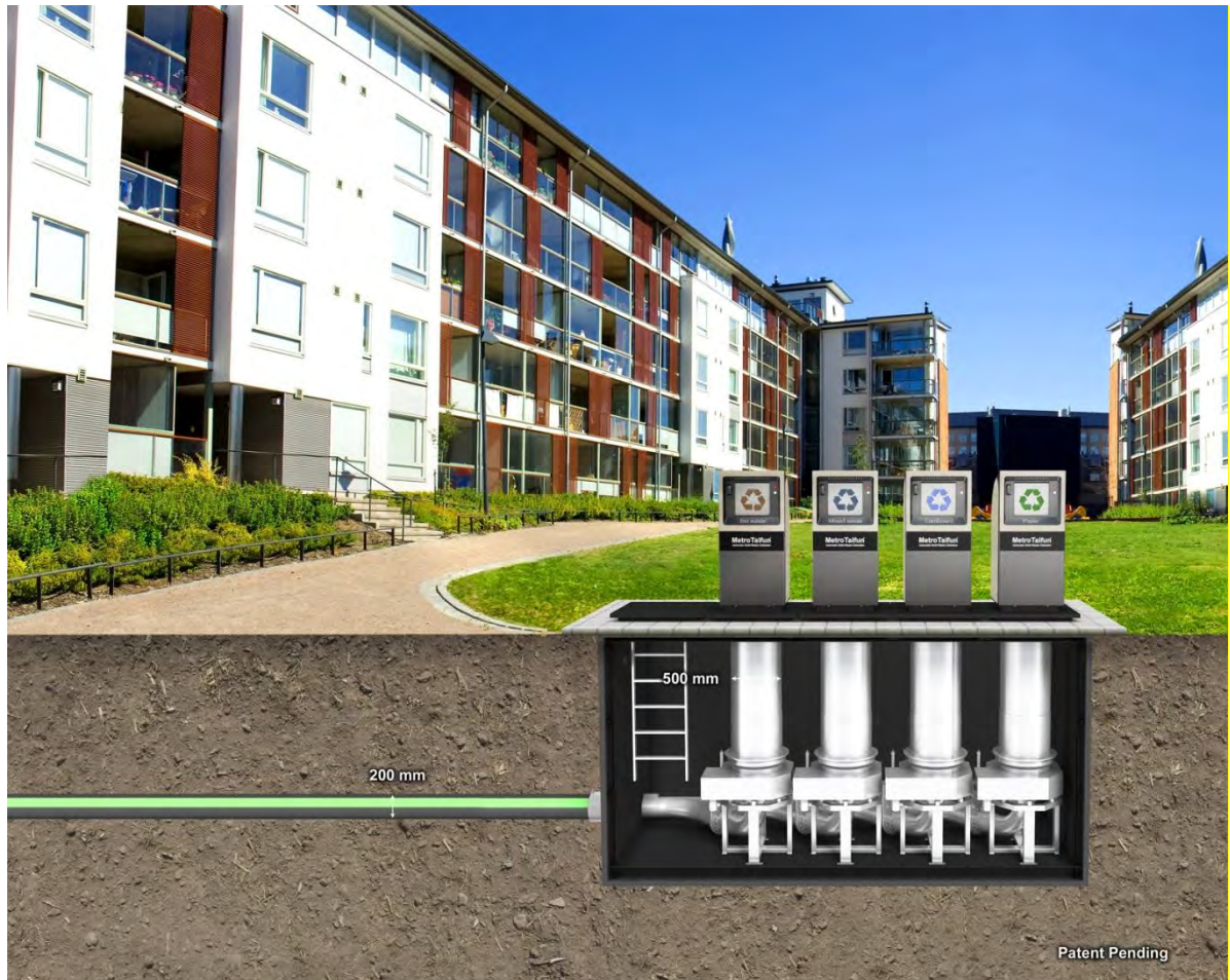
Kuva 27. Esimerkki neljän jätelajin keräyspisteen tilantarpeesta putkikuljetusjärjestelmällä toteutettuna. (Lähde: MariMatic Oy)
