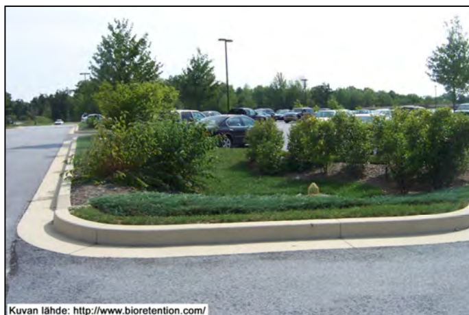
Kuva 14. Hulevesien viivyttäminen paikoitusalueen yhteyteen rakennetussa biopidätyspainanteessa (Kuva. www.bioretention.com )
