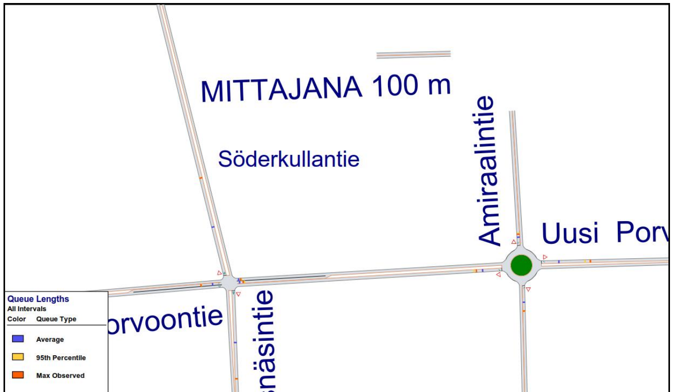
Kuva 12a. Jonopituudet Uuden Porvoontien ja Söderkullantien sekä Amiraalintien liittymissä 1,5 -kertaisella iltahuipun ennusteliikenteellä. Nykyiset liittymäjärjestelyt.
