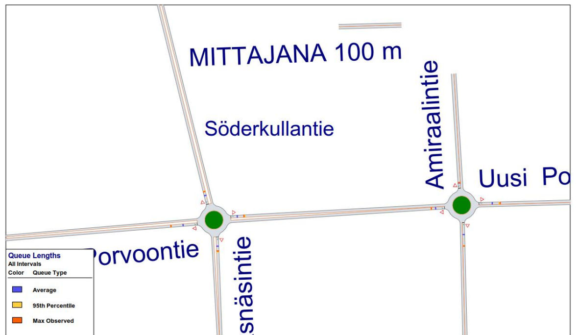
Kuva 14. Jonopituudet Söderkullantien ja Amiraalintien kiertoliittymissä Uudella Porvoontieellä 1,5-kertaisella huipputuntiliikenteellä (iltahuippu).
