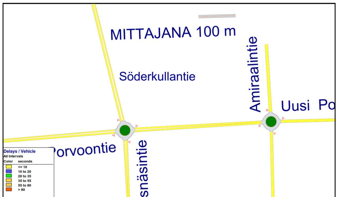
Kuva 15. Keskimääräiset ajoneuvoviivytykset Söderkullantien ja Amiraalintien kiertoliittymissä Uudella Porvoontieellä 1,5-kertaisella huipputuntiliikenteellä (iltahuippu).
