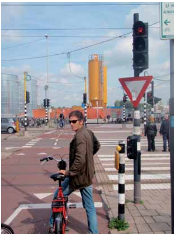
Kuva 28. Esimerkki liikennevalopylväiden ja liikennemerkkien toimivasta sijoittamisesta liit- tymäalueella. Kuva Amsterdamista.
