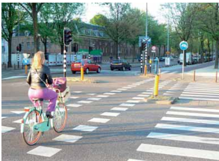
Kuva 26. Esimerkki pyöräilyn sujuvuuden kannalta onnistuneesta pyörätien jatkeesta Belgian Gentistä (kuva Matti Hirvonen). Kääntyvän autoilijan väistötila on saatu toteutettua ris- teysalueelle ja autoilijan väistämisvelvollisuus on osoitettu maalatuin kärkikolmioin.
