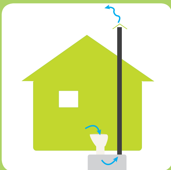
Hajuttomassa kuivakäymälässä ilma kiertää istuimen kautta ulos.
