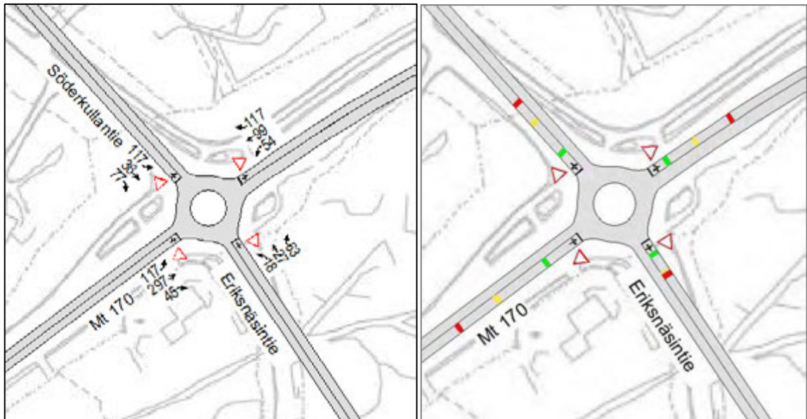
Kuva 7. Söderkullantien ja Uuden Porvoontien liittymän (kiertoliittymä) ennustetilanteen 2025 liikennemäärät ja jonopituudet illan huipputunnilla (kuva: Synchro).
