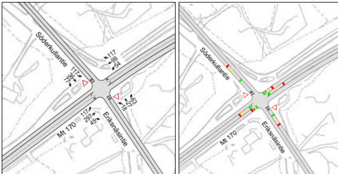
Kuva 6. Söderkullantien ja Uuden Porvoontien liittymän (nelihaara valo-ohjaamaton) ennustetilanteen 2025 liikennemäärät ja jonopituudet illan huipputunnilla (kuva: Synchro).
